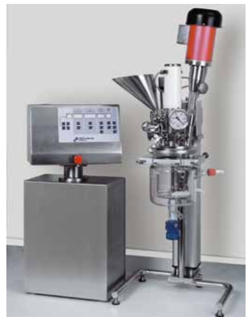
EL1-pm med mantlad glastank 1 liter arbetsvolym.
