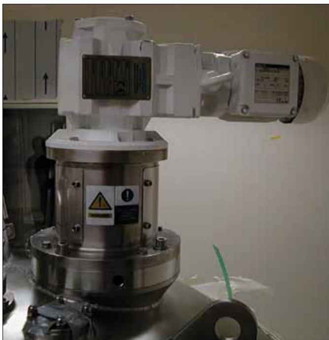
Epoximålad Lightnin SR med syrafast hållare, svetsfläns och tätning från Huhn seal.
