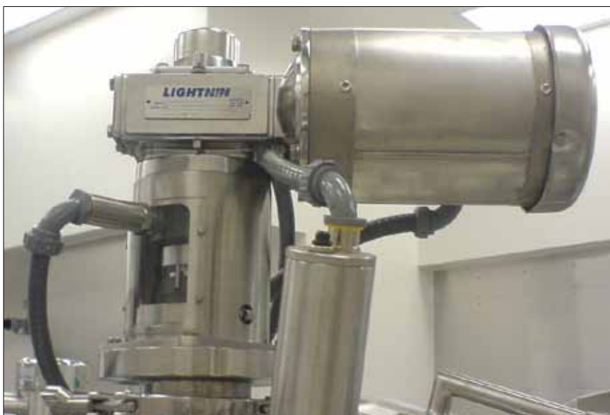
Lightnin SR med torrgående Sanitary tätning från Flowserve. Här med motor och växel i syrafast.
